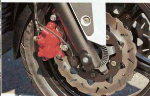
Спереди: красные суппорты, а-ля «лестничные» диски. Датчик ABS уже в комплекте.
