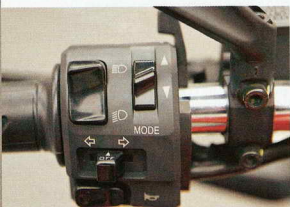
Кнопка Mode – главный и единственный орган управления бортовым компьютером.
