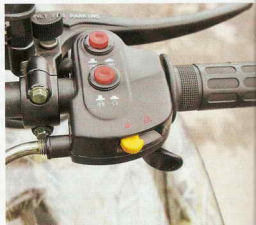
На правом пульте кнопки подключения переднего моста, аварийной сигнализации и стоп двигателя.
