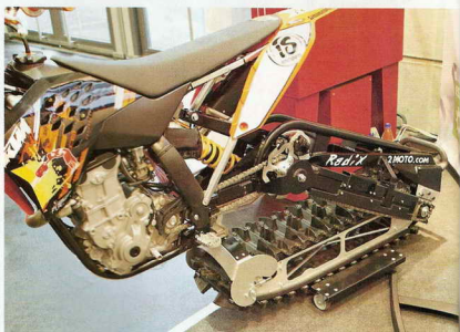
Подвеска и привод гусеницы 2Moto RadiX.
