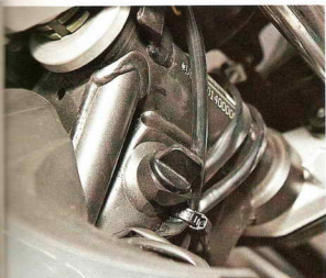
Масляный шпунт здесь «живет» в раме – особенности системной смазки с сухим картером.
