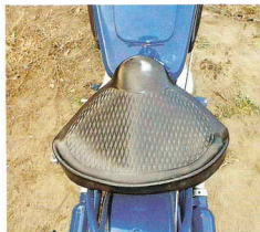
Такое седло прозвали «лагушкой». Оно подружнено, причем жесткость пружины можно регулировать – в зависимости от веса водителя и дорожных условий.
