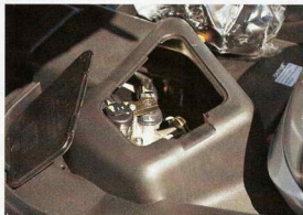
Прямой доступ к инжектору из багажника. Японцы так не делают.
