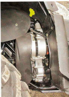
Неприкрытый генератор – главный ограничитель при погружениях ATV в болота.
