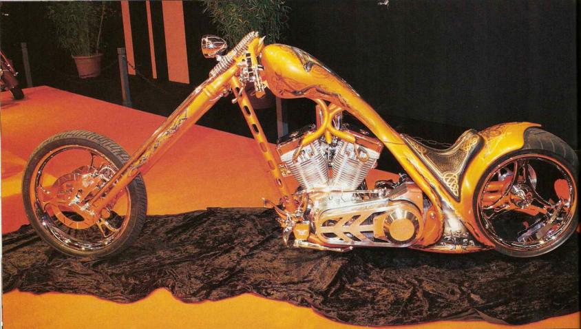
Fenris компании Habermann-Performance – победитель в номинации Chopper/Cruiser. Мотор – S&S Evolution 1852 см 3 . Коробка передач – 6-ступенчатая Baker. Рама-хайнек с 42-градусным рейком и односторонний свингарм – Habermann. Колеса – Speed-point. Передний тормоз – RST, задний – «трансмиссионный» Baker. Художник – Бьянка Хенниг.
