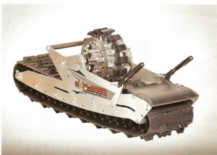
В ките AD Boivin Explorer привод идет прямо на верхнюю часть гусеницы.
