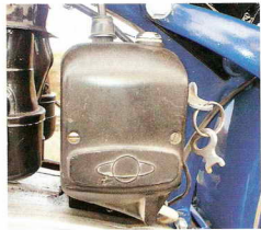
В распределкорбке – bobina зажигания, реле-регулятор, центральный переключатель и предохранитель. Обратите внимание на нетрадиционное расположение – вилку, а не перед глазами – контрольную лампы и ключа зажигания.
