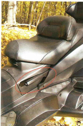
Ручной тормоз на скутер-трайке – вещь необходимая (рычаг под рукой – слева внизу).
