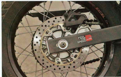
Простенький задний маятник не добавляет устойчивости на больших скоростях.
