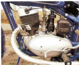
Одноцилиндровый 2-тактный двигатель – в блоке с 4-ступенчатой коробкой передач. За чугунным цилиндром – карбюратор К-285 и воздухофильтр центробежного типа.
