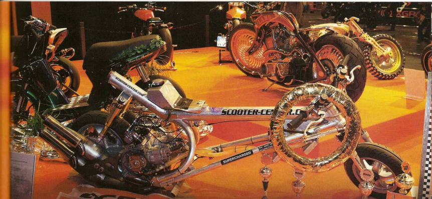
Да, это скутер. И не смотрите на меня так. Twin Dragster of Scooter Center Koin (SCK) построен в 2007 году в честь 15-летия компании. Два мотора Malossi общим объемом 360 см 3 выдают 51,7 л.с. И все-таки это скутер.
