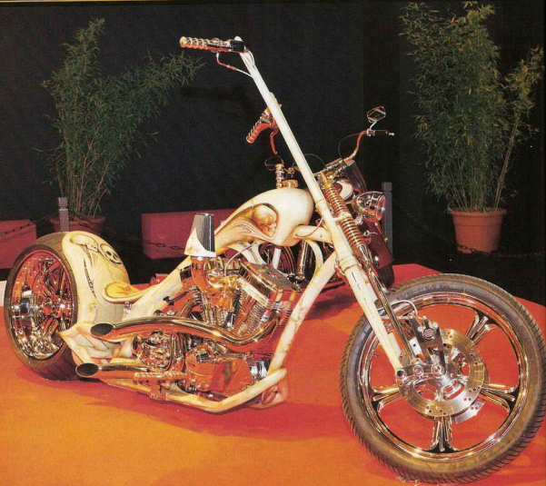
Fenris компании Habermann-Performance – победитель в номинации Chopper/Cruiser. Мотор – S&S Evolution 1852 см 3 . Коробка передач – 6-ступенчатая Baker. Рама-хайнек с 42-градусным рейком и односторонний свингарм – Habermann. Колеса – Speed-point. Передний тормоз – RST, задний – «трансмиссионный» Baker. Художник – Бьянка Хенниг.
