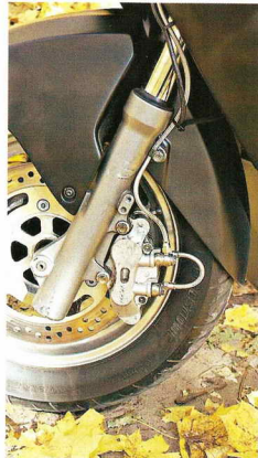
Так выглядят передние суппорты после модернизации тормозной системы.
