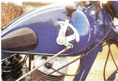
Палка ногового переключения передач дублирована рычагом ручного переключения.
