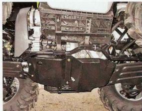
Щитки защищают картер двигателя от повреждений.
