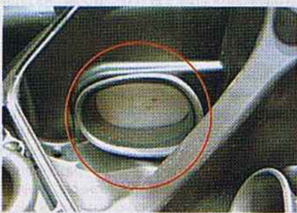
Один из воздуховодов Honda CBR600RR заглушен.
