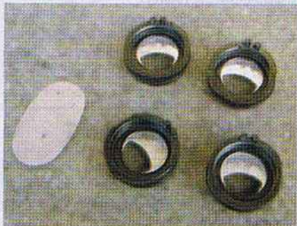
Полный набор вредоносных «шайб». Изъять их – и Honda CBR600RR сможет «дышать» свободно.
