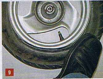
9 На финише операции инструмент не нужен – додавите шину ногами.
