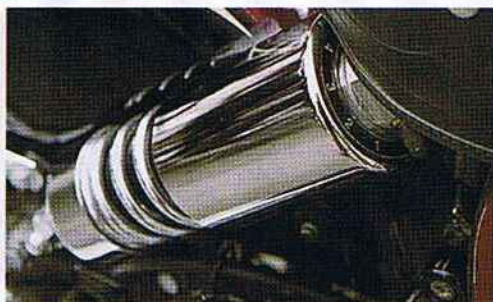
Задний Showa – с регулировками, но мягковат.
