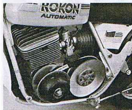
Rokon RT340 значительно опережал в развитии свой 1971 год: силовой агрегат с вариатором (приспособленный от снегохода), дисковые тормоза, литые колеса.
