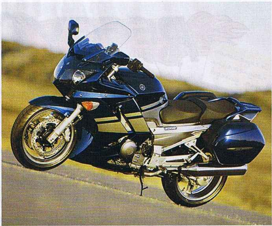
Yamaha FJR1300AS оборудована полуавтоматом переключения передач.
