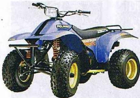
Пolaris Trail Blazer – первый мотовездеход, оснащенный вариатором.
