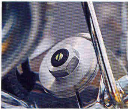
Винт регулировки гидравлики отбоя.
