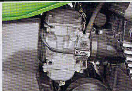
Карбюраторы оборудованы датчиком положения заслонок.
