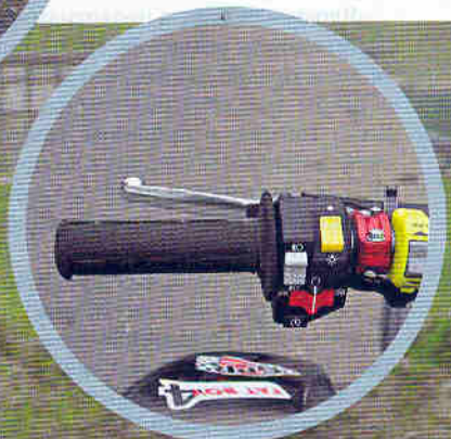
С помощью переключателя (желтого цвета) можно на ходу управлять системой зажигания Vortex
