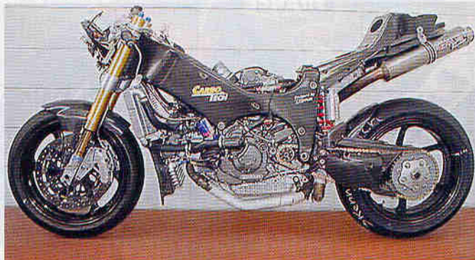
Экспериментальный Ducati 996 с карбоновой рамой.
