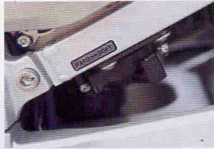
Жесткость задней подвески регулируется рычажком с двумя положениями.
