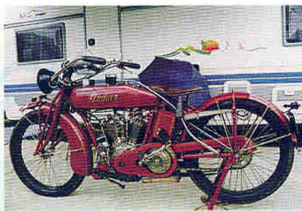
Indian начала 20-х годов – настоящий хай-тек своих времен. И передняя, и задняя подвеска – на листовых рессорах.
