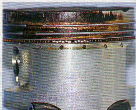
На юбке поршня лишь легкая потертость – он практически не изношен. Нагар на верхней части поршня – следствие неправильной работы карбюратора, а также износа колец.
