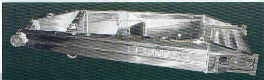
Маятники мотоциклов Endurance часто заменяют менее жесткими. Один из таких маятников производится компанией Spondon Engineering.
