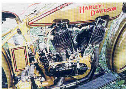
Двигатель Harley-Davidson образца 1929 года. Вырезы в бензобаке сделаны для размещения привода верхних впускных клапанов (выпускные – нижние).
