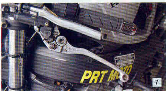
Верхний рычаг на руле – сцепление, нижний – задний тормоз.
