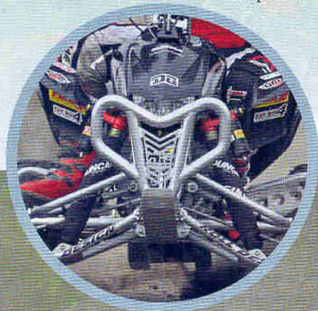
Передняя подвеска: рычаги Roll Design амортиз Elka Elinte
