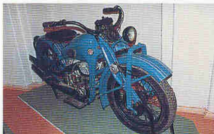
Советский ПМЗ А-750 – соединение V-twin'a американского образца с шасси немецкой школы.
