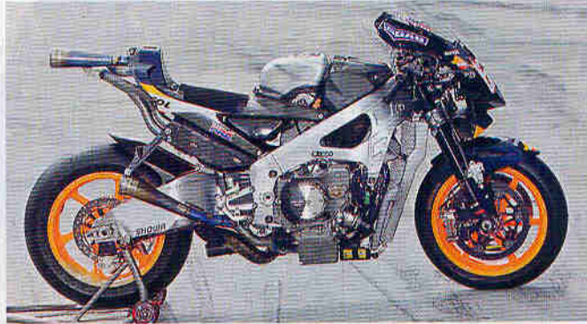
У Honda RC211V эталонная, по современным понятиям, алюминиевая рама.
