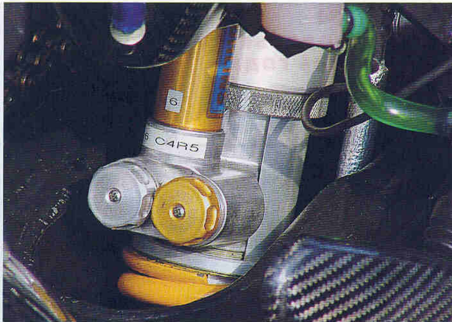
Моноамортизатор Yamaha YZR-M1: на стикере указаны параметры последних настроек демпфирования сжатия и отбоя.
