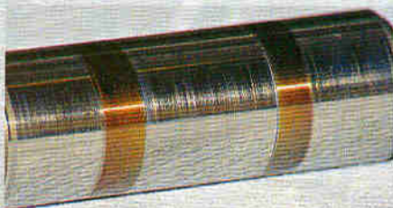
Износ в средней части пальца – следствие «перекруток» мотора.
