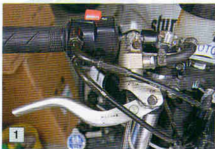
1 Главный тормозной цилиндр радиального типа сделает передний тормоз более эффективным.
