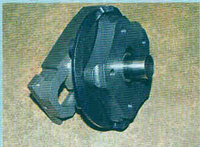
Устройство для быстрой замены заднего колеса (Sponton Engineering).
