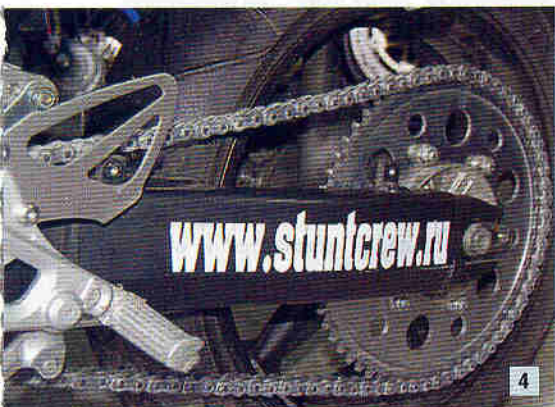
Звезда на 60 зубьев на заднем колесе.
