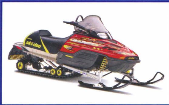
"Skandic WT600". Впервые на утилитарном "Ski-Doo" используется передовая передняя подвеска на продольных тягах
