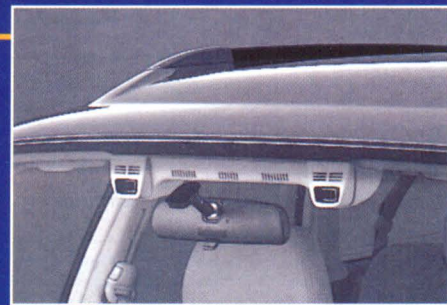
Две камеры возле зеркала оценивают расстояние до едущей впереди машины
