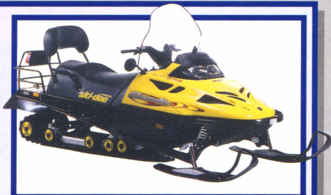
"Skandic WT600". Впервые на утилитарном "Ski-Doo" используется передовая передняя подвеска на продольных тягах
