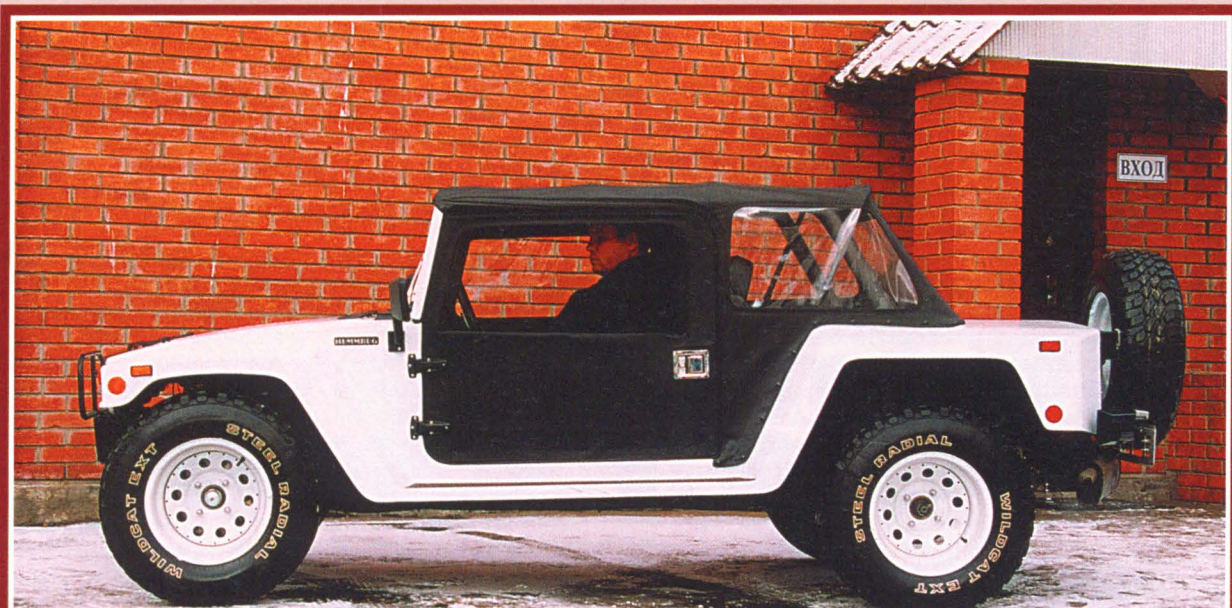
Матерчатые двери и тент можно снять за пять минут, и машина превратится в кабриолет
