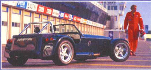
Вариация на тему "Super Seven" из Голландии: родстер "Donkervoort" изготавливается на основе агрегатов "Audi"
