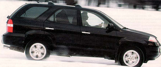
На скользкой дороге режим "4x4" включается автоматически, когда передние колеса начинают пробуксовывать.
