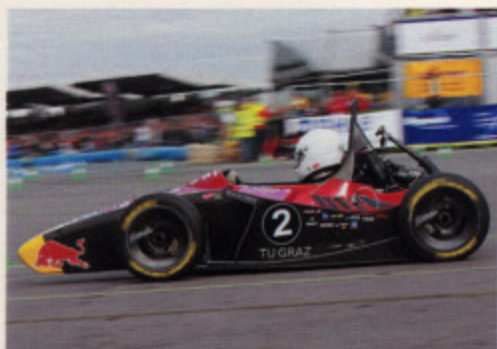
Австрийский технический университет Граца завоевал в Германии второе место и получил специальный приз компании Audi «За лучшее использование легких материалов»: из углепластика выполнен не только монокок, но и рычаги подвески, а также колесные диски
