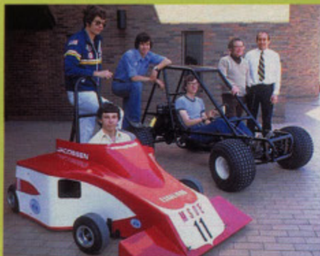
Некоторые команды на заре Формулы SAE предпочитали построить здоровенный карт вместо гоночного автомобиля. В результате организаторы сделали обязательным использование эластичной подвески и ввели тест, проверяющий ее работу
