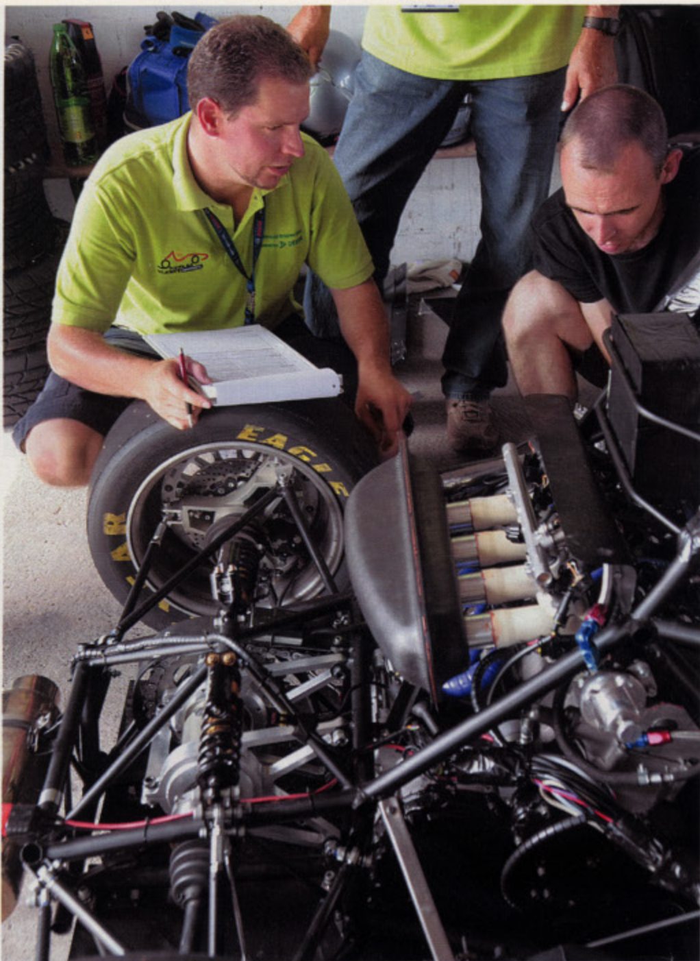
Судьи проверяют геометрию рамы, надежность крепления агрегатов, правильность прокладки топливных и тормозных магистралей, их целостность
