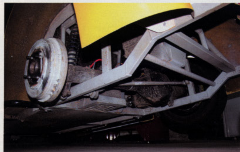
Сзади — неразрезной мост на продольных рычагах с тягой Панара и барабанные тормоза. Амортизаторы Bilstein — без регулировок, но пружины можно подбирать по жесткости
