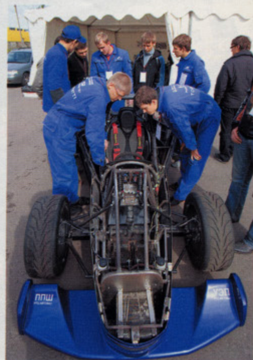
На техинспекции пилот должен покинуть кокпит не более чем за пять секунд. С секундомером — куратор тольяттинской команды, один из топ-инженеров АвтоВАЗа Игорь Иванов
