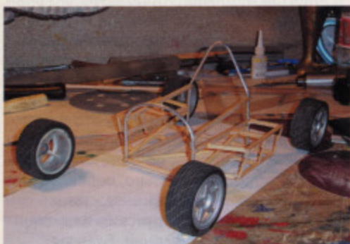
Прежде чем садиться за компьютер, многие предпочитают прикинуть компоновку на модели из деревянных реек
