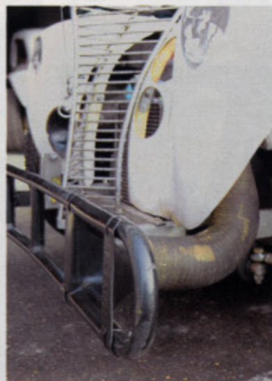
Мотоциклетный мотор развернут продольно, что создает проблемы с охлаждением четвертого цилиндра. Во избежание перегрева на Легендах установлены дополнительные воздуховоды (на фото справа), а после финиша мотор полагается обдувать вентилятором. Радиатор перед двигателем — масляный
