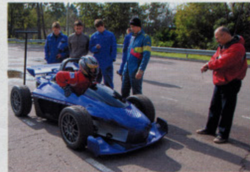
На техинспекции пилот должен покинуть кокпит не более чем за пять секунд. С секундомером — куратор тольяттинской команды, один из топ-инженеров АвтоВАЗа Игорь Иванов
