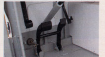
Сдвоенная педаль тормоза нужна, чтобы не цепляться левой ногой за рулевой вал. Все педали — с очень короткими ходами
