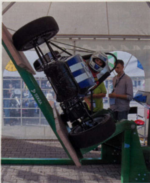
Машина из МАМИ проходит тест на поворотном столе: при поперечном уклоне в 60 градусов формула не должна опрокинуться. Здесь же проверяется герметичность топливного и расширительного бачков
