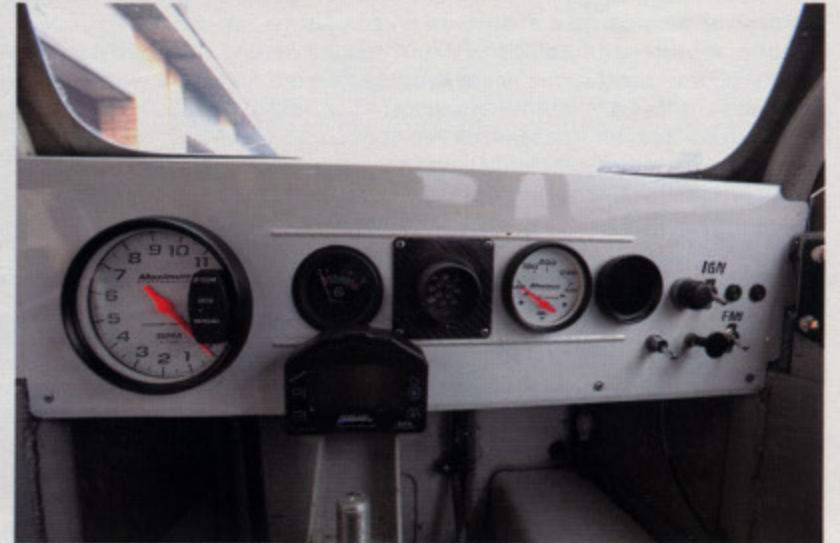
Слева направо: тахометр с памятью, указатель давления масла, лампа, подсказывающая момент переключения, указатель температуры масла, указатель включенной передачи
