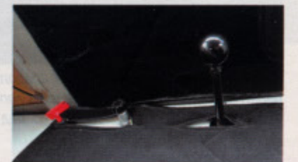
В мотоциклетной коробке первая ступень включается движением рычага вперед, остальные — на себя. Задней передачи нет вовсе. Перед рычагом — опционный регулятор тормозных усилий
