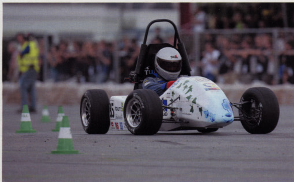
На немецком конкурсе Formula Student 2008 года первенствовала команда технического университета голландского города Дельфта: углепластиковый монокок, 450-кубовый одноцилиндровый двигатель Yamaha с жидкостным охлаждением, переведенный на биоэтанол, 10-дюймовые колеса и снаряженная масса всего 158 килограммов
