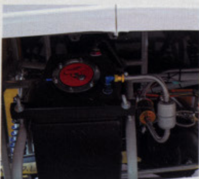
Бензобак емкостью около 18 литров установлен за спиной пилота. Топливо — бензин АИ-95
