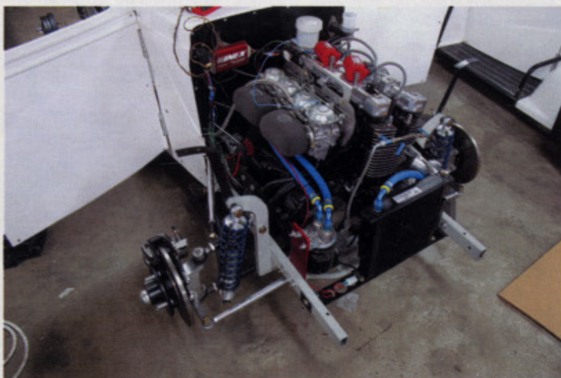
Мотоциклетный мотор развернут продольно, что создает проблемы с охлаждением четвертого цилиндра. Во избежание перегрева на Легендах установлены дополнительные воздуховоды (на фото справа), а после финиша мотор полагается обдувать вентилятором. Радиатор перед двигателем — масляный
