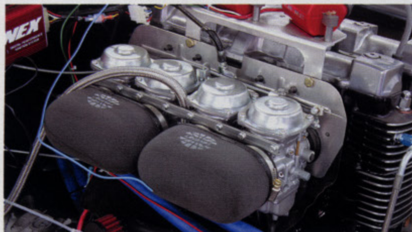
Система питания — четыре горизонтальных карбюратора
